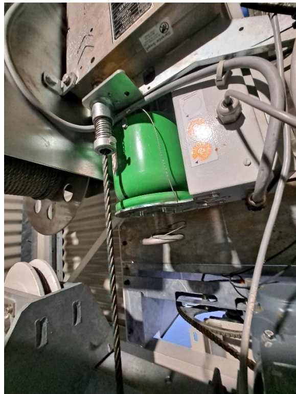
Manuell heis SZ-sikkerhet, festet for bruk
